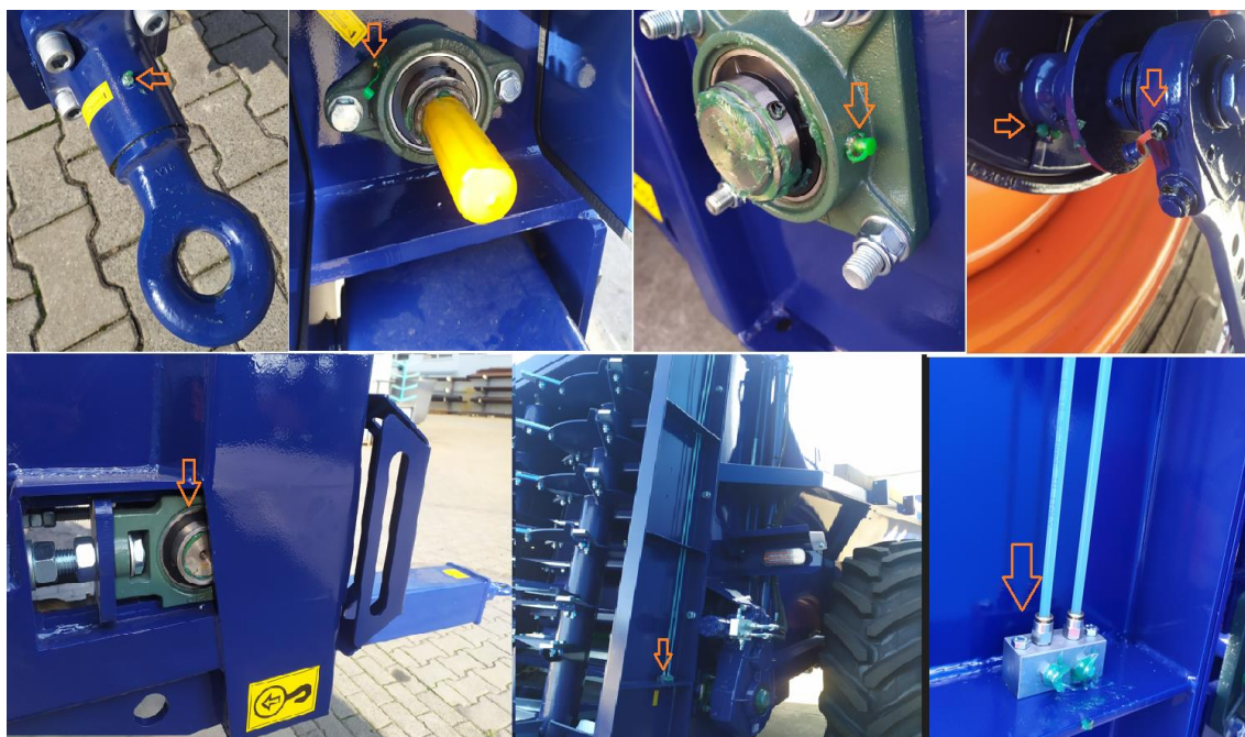
Rysunek 25 Miejsca smarowania smarem np. ŁT43
